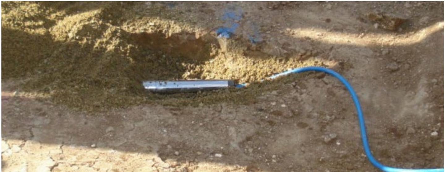
*Piézomètre à corde vibrante placé dans les fondations d'un barrage en terre*
